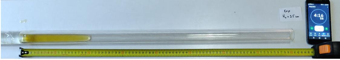
Figure 4: Matériel nécessaire pour l'expérience simple : un tube de plastique transparent, du miel, un chronomètre et un mètre ruban. Sur l'image, on voit la propagation du front qui se trouve à 20 cm du bout du tube, 4 min et 16 s après le début de l'expérience.
